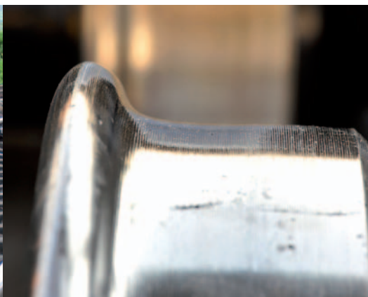
Glattes Rad (V-Sohle) mindert das Rollgeräusch
